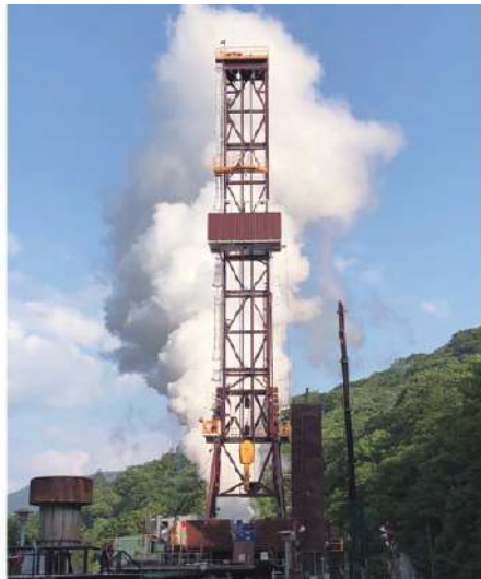
当社所有・最新鋭の3,000m級大型掘削リグ 地下のターゲットに向けて地熱井を掘削する
